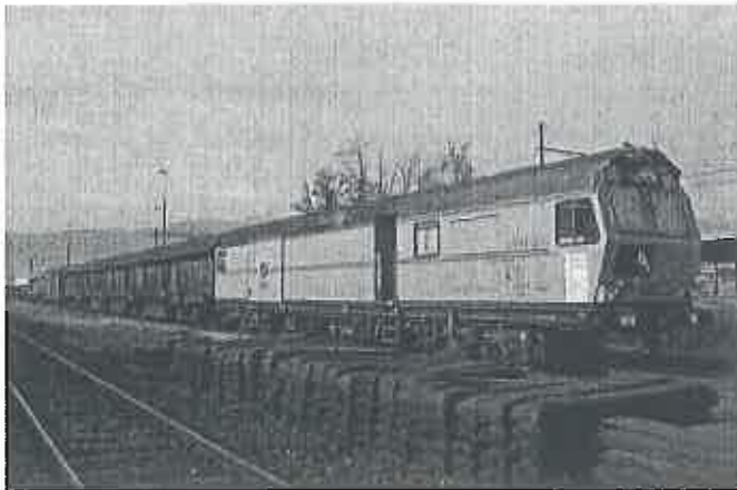
Train meuleur de rails (Scheuchzer S.A.)
