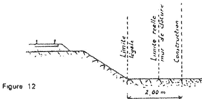
Il en résulte des dispositions précédentes que si les clôtures sont autorisées à la limite réelle du Chemin de Fer, les constructions doivent être établies en retrait de cette limite réelle dans le cas où celle-ci est située à moins de 2 mètres de la limite légale.
