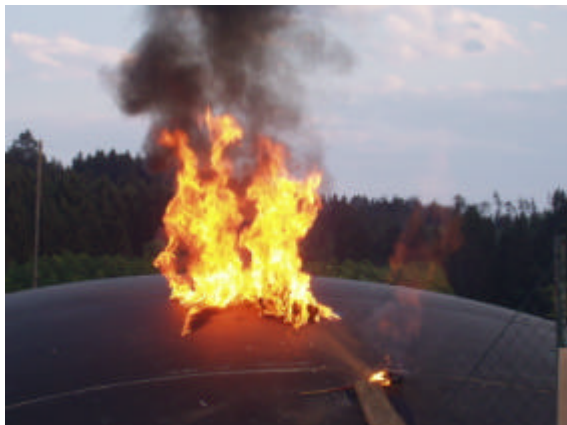
Image 10 + 11: 6. Un chiffon imbibé d'essence, enflammé, est jeté sur la membrane de stockage
