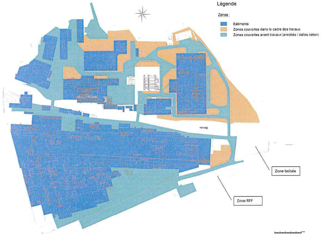
Figure 26 : Localisation des zones recouvertes lors des travaux (source Antea Group)
