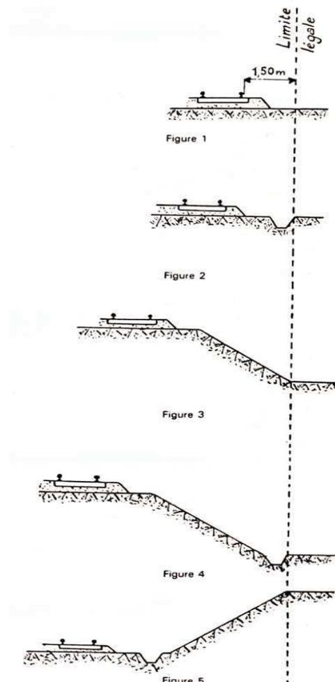
Dans le cas d'une voie posée à flanc de coteau, la limite légale à considérer est constituée par le point extrême des déblais ou remblais effectués pour la construction de la ligne et non la limite du talus naturel (figures 6 et 7)
