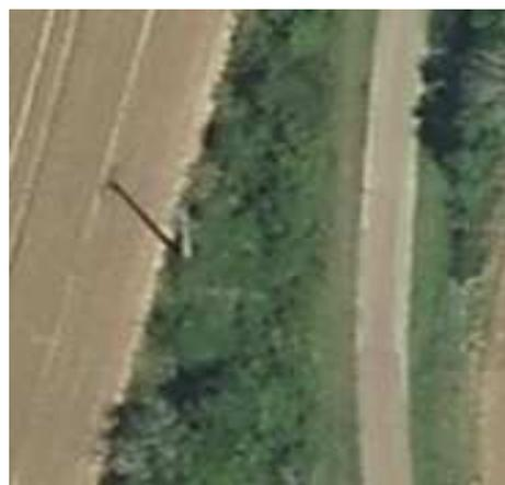
La position cartographique du pylône sur l'ortho-image se trouvera exactement à l'intersection de ces deux traces. La taille de l'image laissée par une face verticale s'appelle « le dévers ».
