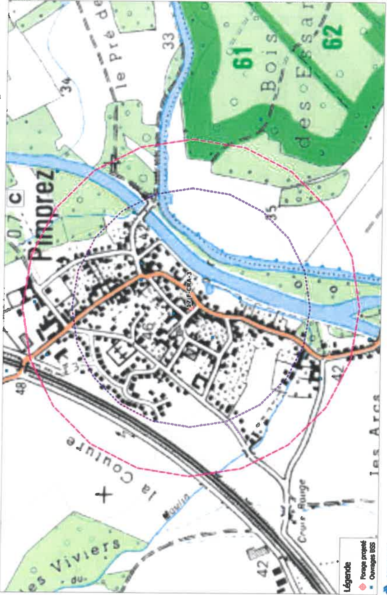
Figure 44 - Rayon d'action engendré par un pompage longue durée à Q = 30 \text{ m}^3/\text{h} au droit du forage 17-F-CRA-3 (Pimprez)
