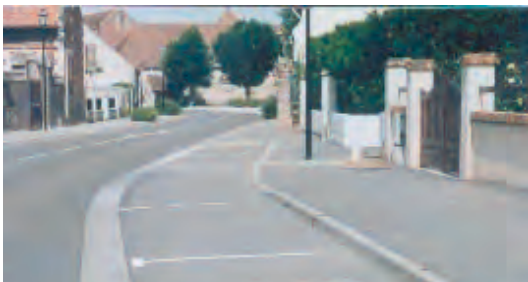
Stationnement matérialisé sur route principale ; les matériaux auraient pu être plus "ruraux" et la largeur du trottoir aurait permis de garder une bande plantée.
