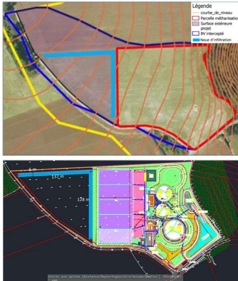
Figure 8 : Schéma de principe de l'implantation de la noue d'infiltration
