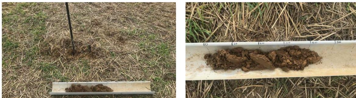
Le prélèvement 4.1 n'a pu être réalisé que sur 40cm dû à la dureté du sol, aucune trace d'oxydoréduction n'est présente.
