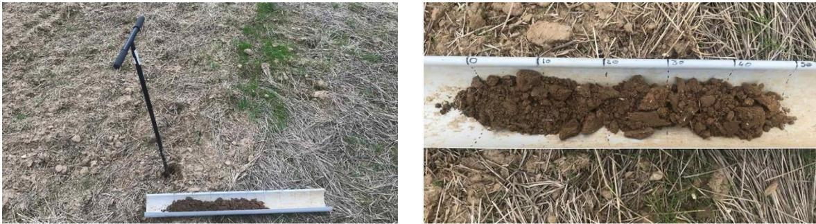
Sur le carottage du point de prélèvement 3.8, on ne retrouve aucune trace d'oxydoréduction jusqu'à 50 cm.
