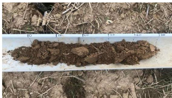
Sur le carottage du point de prélèvement 3.4, on ne retrouve aucune trace d'oxydoréduction jusqu'à 50 cm.
