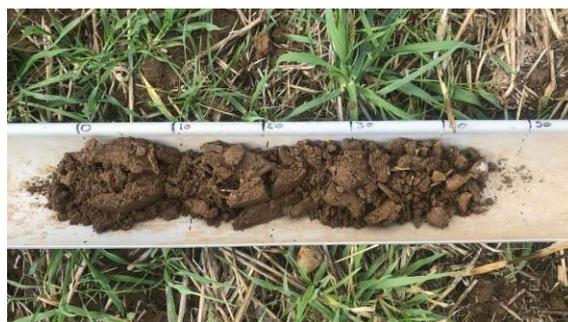
Sur le carottage du point de prélèvement 1.4, on ne retrouve aucune trace d'oxydoréduction jusqu'à 50 cm.
