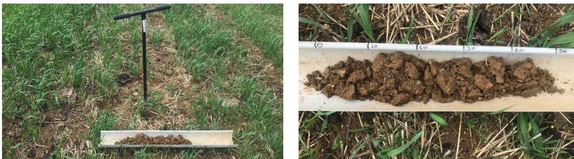
Sur le carottage du point de prélèvement 2.7, on ne retrouve aucune trace d'oxydoréduction jusqu'à 50 cm.
