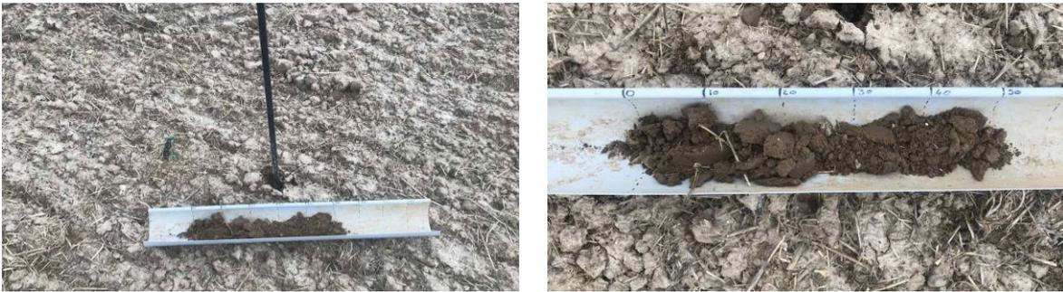
Sur le carottage du point de prélèvement 6.1, on ne retrouve aucune trace d'oxydoréduction jusqu'à 50 cm.
