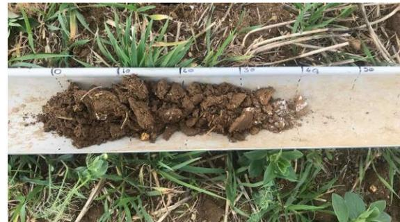
Le prélèvement 1.6 n'a pu être réalisé que sur 40cm dû à la présence de nombreux cailloux, aucune trace d'oxydoréduction n'est observable.
