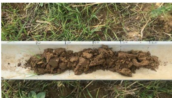
Sur le carottage du point de prélèvement 1.3, on ne retrouve aucune trace d'oxydoréduction jusqu'à 50 cm.
