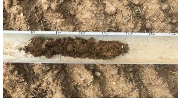
Le prélèvement PL2 n'a pu être réalisé que sur 40cm dû à la dureté du sol, aucune trace d'oxydoréduction n'est présente.
