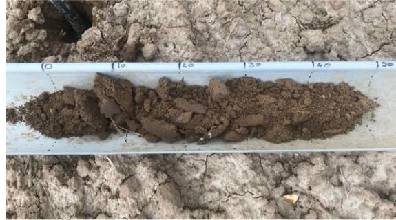
Sur le carottage du point de prélèvement 6.4, on ne retrouve aucune trace d'oxydoréduction jusqu'à 50 cm.
