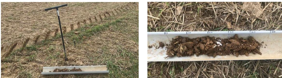
Sur le carottage du point de prélèvement 4.2, on ne retrouve aucune trace d'oxydoréduction jusqu'à 50 cm.
