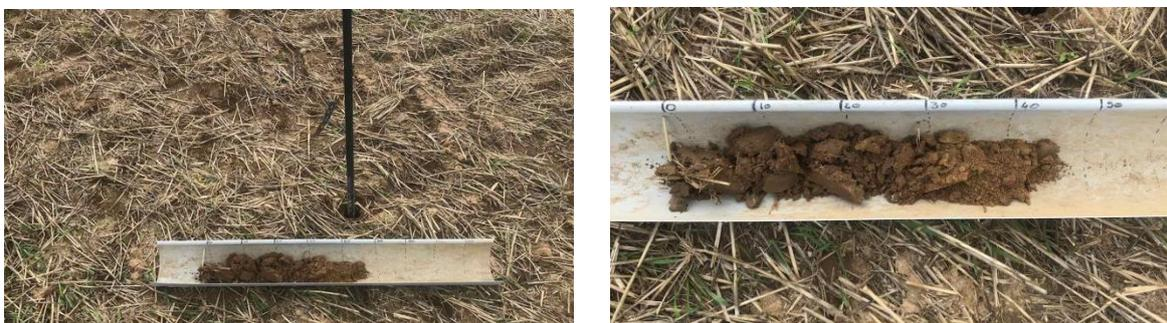
Le prélèvement 4.3 n'a pu être réalisé que sur 40cm dû à la dureté du sol, aucune trace d'oxydoréduction n'est présente.
