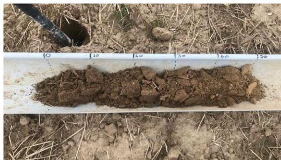
Sur le carottage du point de prélèvement 3.2, on ne retrouve aucune trace d'oxydoréduction jusqu'à 50 cm.
