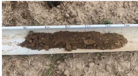
Sur le carottage du point de prélèvement 3.7, on ne retrouve aucune trace d'oxydoréduction jusqu'à 50 cm.
