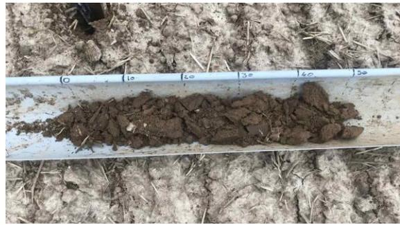
Sur le carottage du point de prélèvement 6.8, on ne retrouve aucune trace d'oxydoréduction jusqu'à 50 cm.
