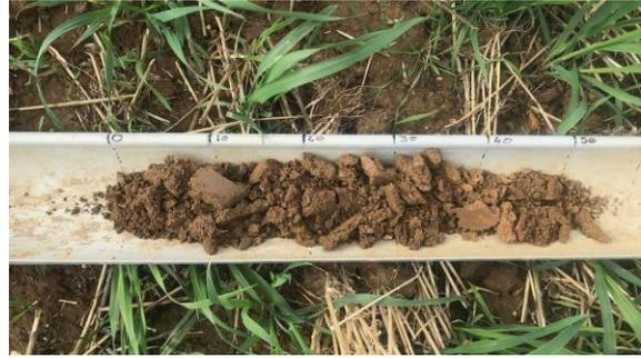
Sur le carottage du point de prélèvement 2.4, on ne retrouve aucune trace d'oxydoréduction jusqu'à 50 cm.
