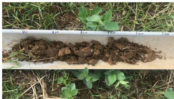
Sur le carottage du point de prélèvement 1.2, on ne retrouve aucune trace d'oxydoréduction jusqu'à 50 cm.
