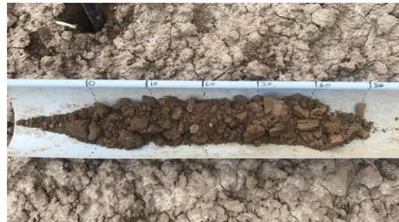
Sur le carottage du point de prélèvement 6.6, on ne retrouve aucune trace d'oxydoréduction jusqu'à 50 cm.
