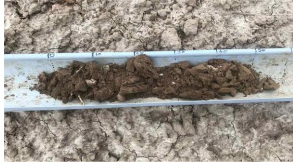
Sur le carottage du point de prélèvement 6.7, on ne retrouve aucune trace d'oxydoréduction jusqu'à 50 cm.
