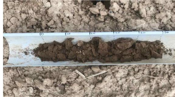
Sur le carottage du point de prélèvement 6.5, on ne retrouve aucune trace d'oxydoréduction jusqu'à 50 cm.
