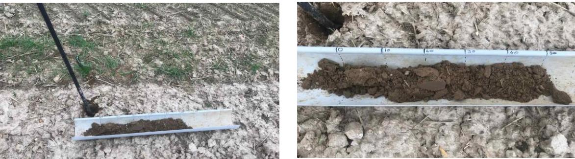
Sur le carottage du point de prélèvement 6.2, on ne retrouve aucune trace d'oxydoréduction jusqu'à 50 cm.
