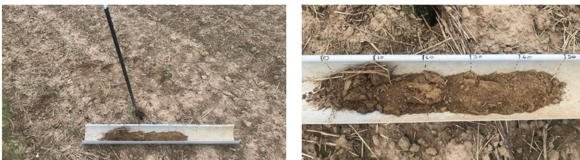
Sur le carottage du point de prélèvement 3.1, on ne retrouve aucune trace d'oxydoréduction jusqu'à 50 cm.
