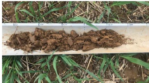
Sur le carottage du point de prélèvement 2.6, on ne retrouve aucune trace d'oxydoréduction jusqu'à 50 cm.
