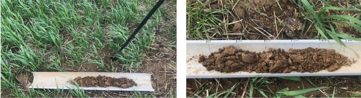
Sur le carottage du point de prélèvement 2.1, on ne retrouve aucune trace d'oxydoréduction jusqu'à 50 cm.
