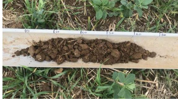
Le prélèvement 1.5 n'a pu être réalisé que sur 40cm dû à la dureté du sol, aucune trace d'oxydoréduction n'est observable.
