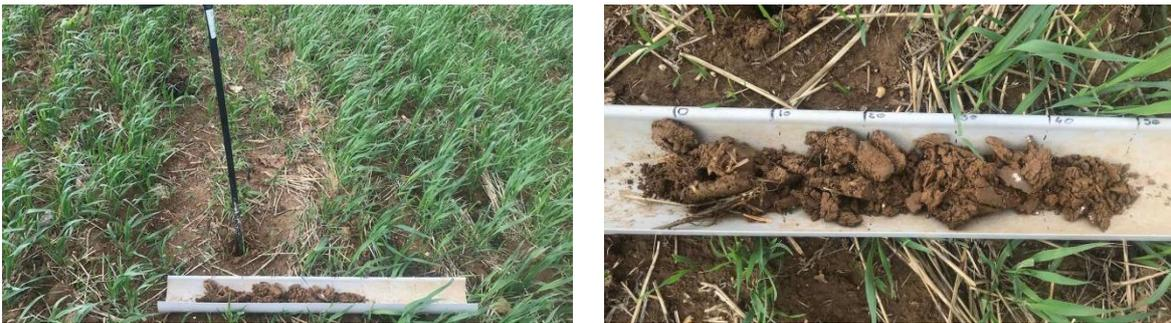
Sur le carottage du point de prélèvement 2.3, on ne retrouve aucune trace d'oxydoréduction jusqu'à 50 cm.
