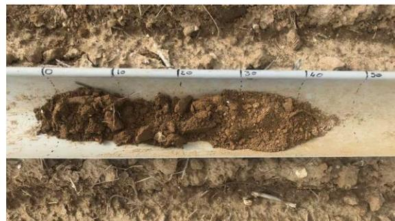
Le prélèvement PL1 n'a pu être réalisé que sur 40cm dû à la dureté du sol, aucune trace d'oxydoréduction n'est présente.
