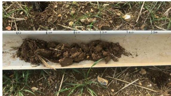
Le prélèvement 1.1 n'a pu être réalisé que sur 40cm dû à la dureté du sol. Aucune trace d'oxydoréduction n'est présente.
