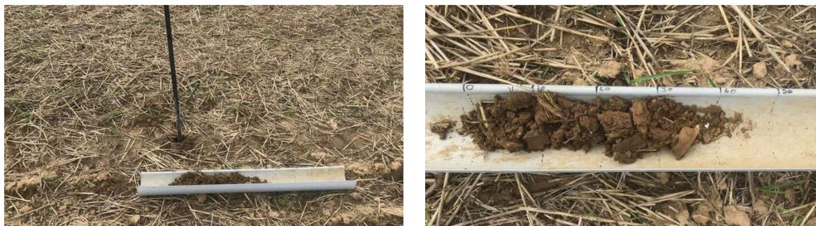
Le prélèvement 4.4 n'a pu être réalisé que sur 40cm dû à la dureté du sol, aucune trace d'oxydoréduction n'est présente.
