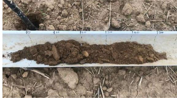
Sur le carottage du point de prélèvement 3.5, on ne retrouve aucune trace d'oxydoréduction jusqu'à 50 cm.
