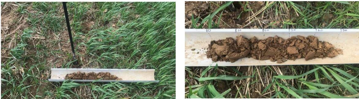
Sur le carottage du point de prélèvement 2.2, on ne retrouve aucune trace d'oxydoréduction jusqu'à 50 cm.
