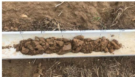
Sur le carottage du point de prélèvement 5.3, on ne retrouve aucune trace d'oxydoréduction jusqu'à 50 cm.
