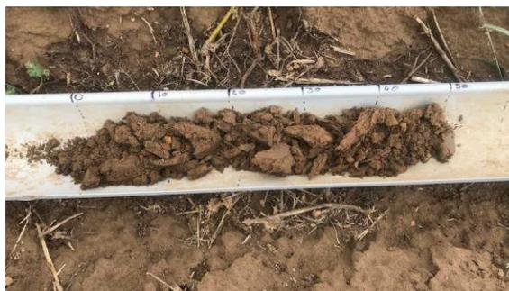
Sur le carottage du point de prélèvement 5.1, on ne retrouve aucune trace d'oxydoréduction jusqu'à 50 cm.
