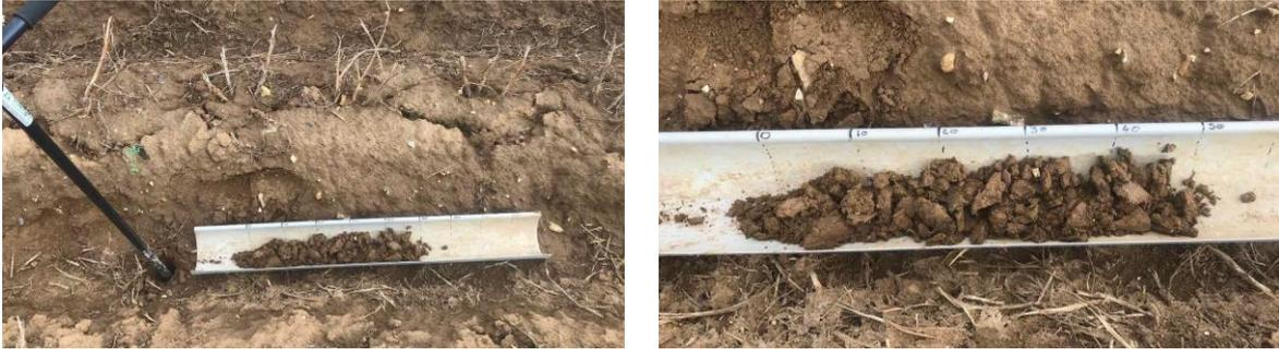
Sur le carottage du point de prélèvement 5.4, on ne retrouve aucune trace d'oxydoréduction jusqu'à 50 cm.
