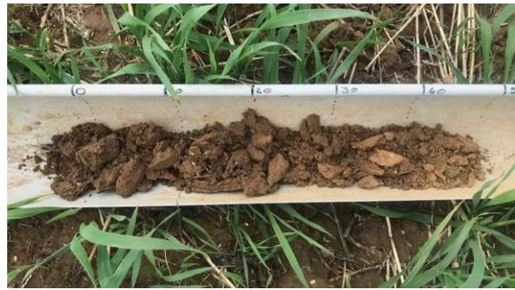
Sur le carottage du point de prélèvement 2.5, on ne retrouve aucune trace d'oxydoréduction jusqu'à 50 cm.
