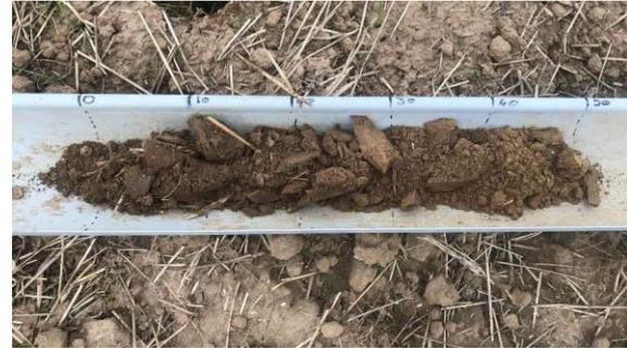
Sur le carottage du point de prélèvement 3.6, on ne retrouve aucune trace d'oxydoréduction jusqu'à 50 cm.
