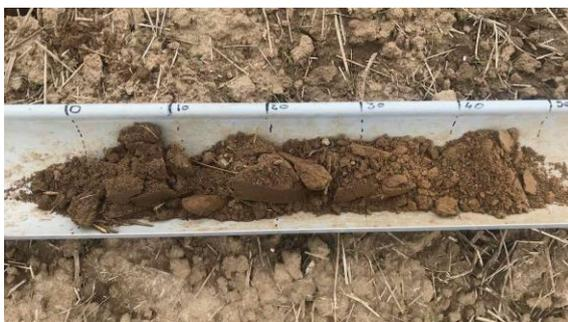
Sur le carottage du point de prélèvement 3.3, on ne retrouve aucune trace d'oxydoréduction jusqu'à 50 cm.
