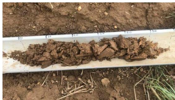
Sur le carottage du point de prélèvement 5.2, on ne retrouve aucune trace d'oxydoréduction jusqu'à 50 cm.
