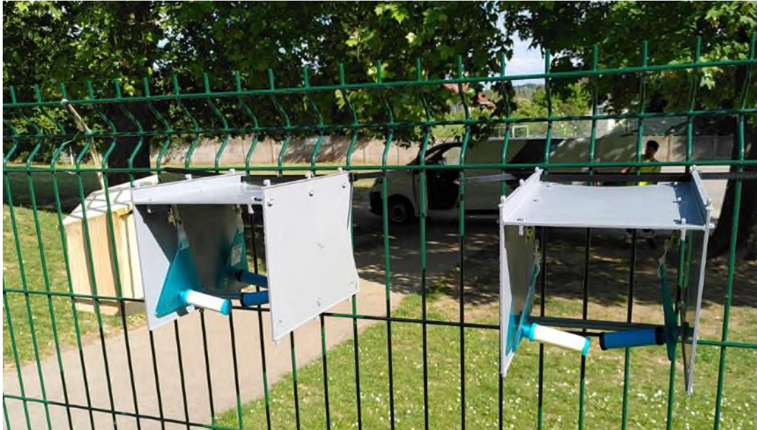
Figure 7-2 Photographie des tubes Radiello et les abris de protection utilisés (point témoin)
