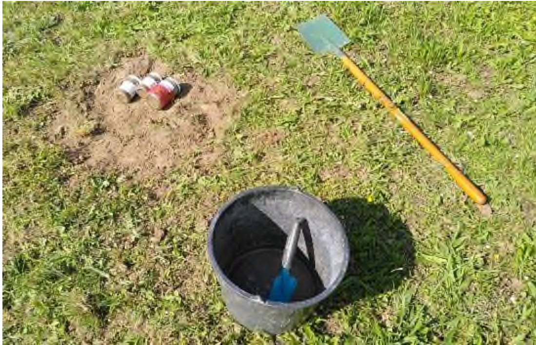
Figure 8-1 Illustration de la technique de prélèvements de sols superficiels (Point IEM_Témoin)
