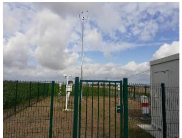
Figure 6-15 Photographie de la station TAUW positionnée à 2m60 du sol (à gauche) et de la station de Bailleul-le-Soc positionnée à environ 10m du sol (à droite)
