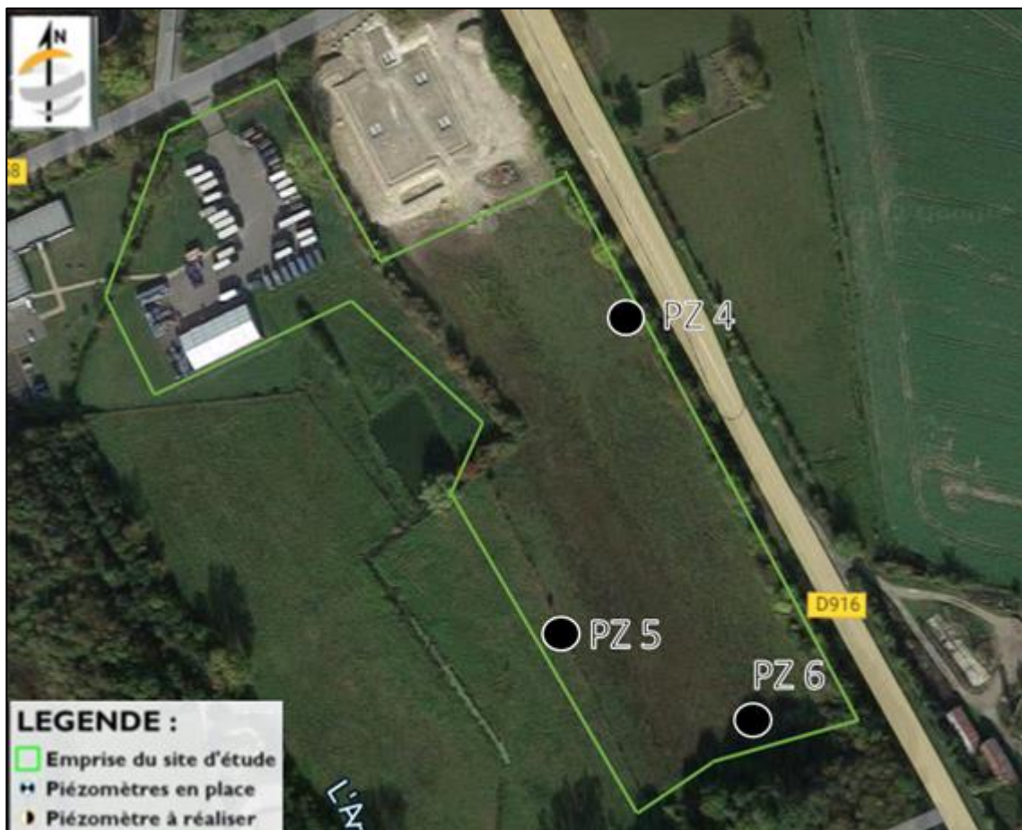
Figure 1 : Localisation des nouveaux piézomètres prévus sur l’emprise VSJ2
