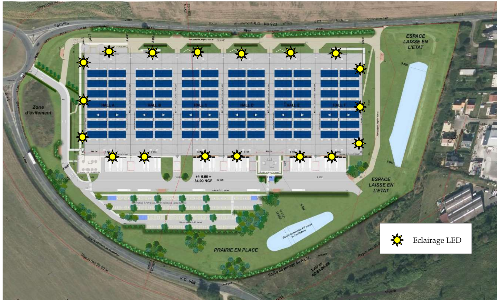
Figure 10 : Mise en place de l'éclairage extérieur
