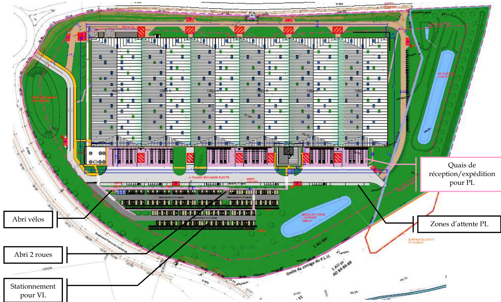
Figure 53 : Localisation des zones d'attente, des quais et des places de stationnement tout véhicule
