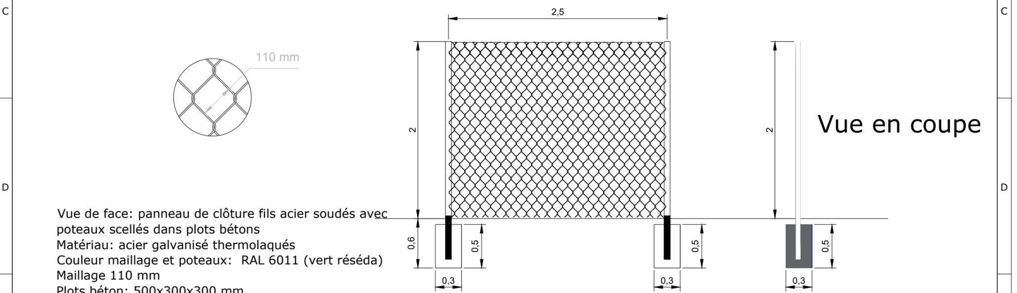
Vue de face: panneau de clôture fils acier soudés avec poteaux scellés dans plots bétons
