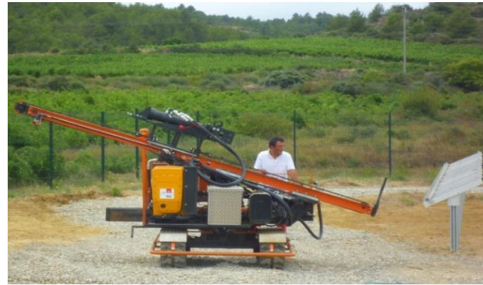
Machine de battage de pieux – Source : Luxel
