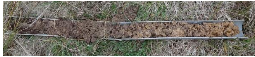
Exemple d'une carotte de sol réalisée suite à un sondage
