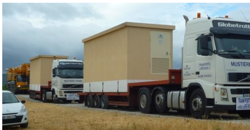
Convoi exceptionnel : Transport des locaux techniques
