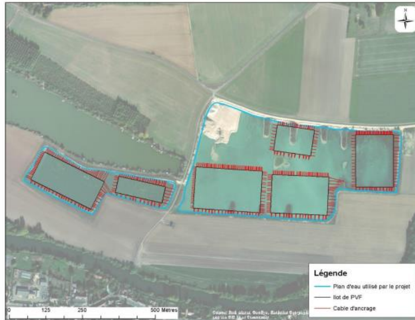
Figure 6 : Localisation des ancrages des îlots
