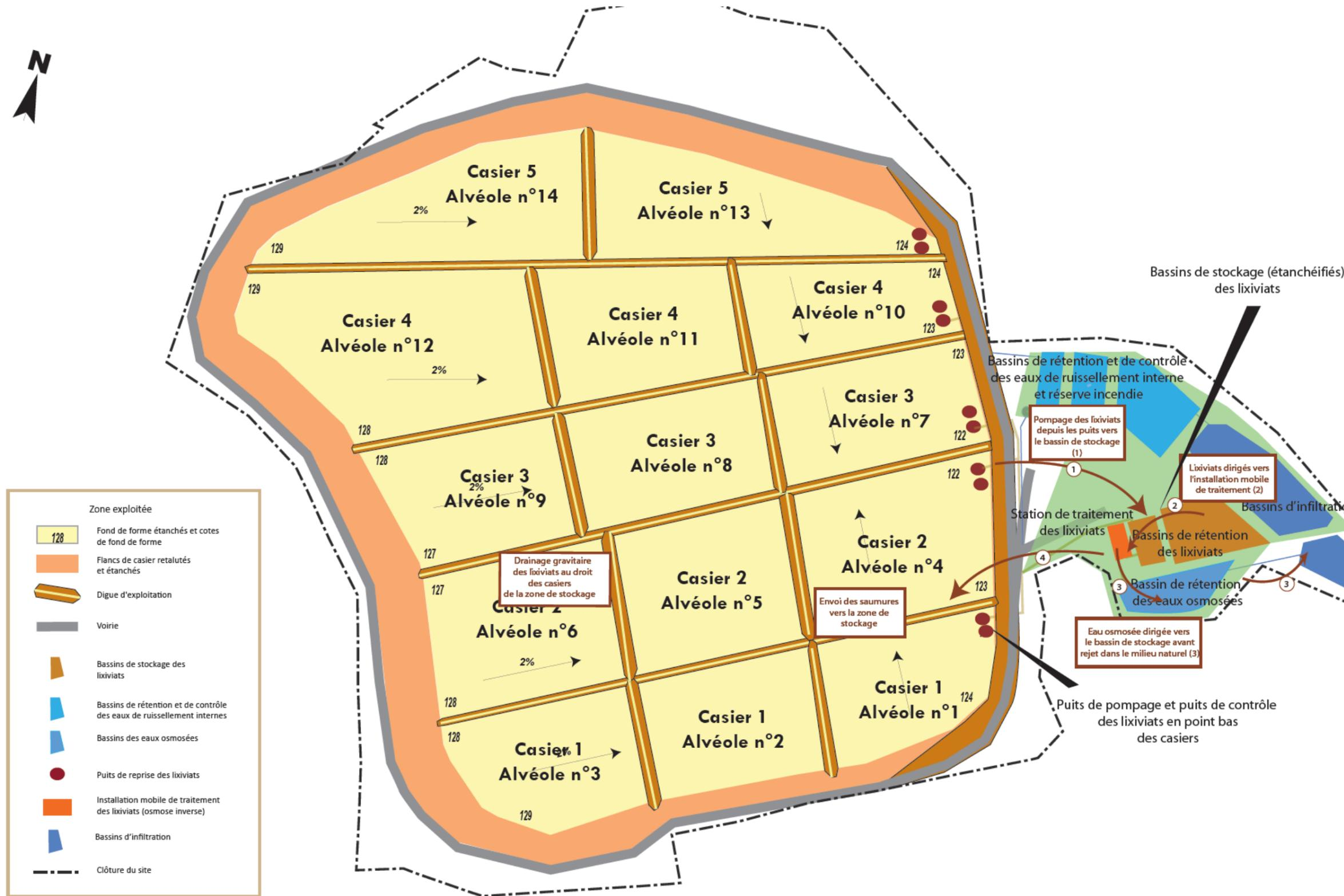
Figure 34 – Schéma de principe de la gestion des lixiviats
