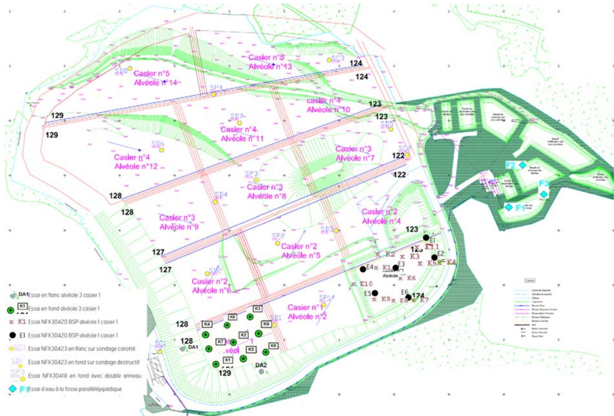
Figure 28 : implantation des tests hydrauliques sur le projet
