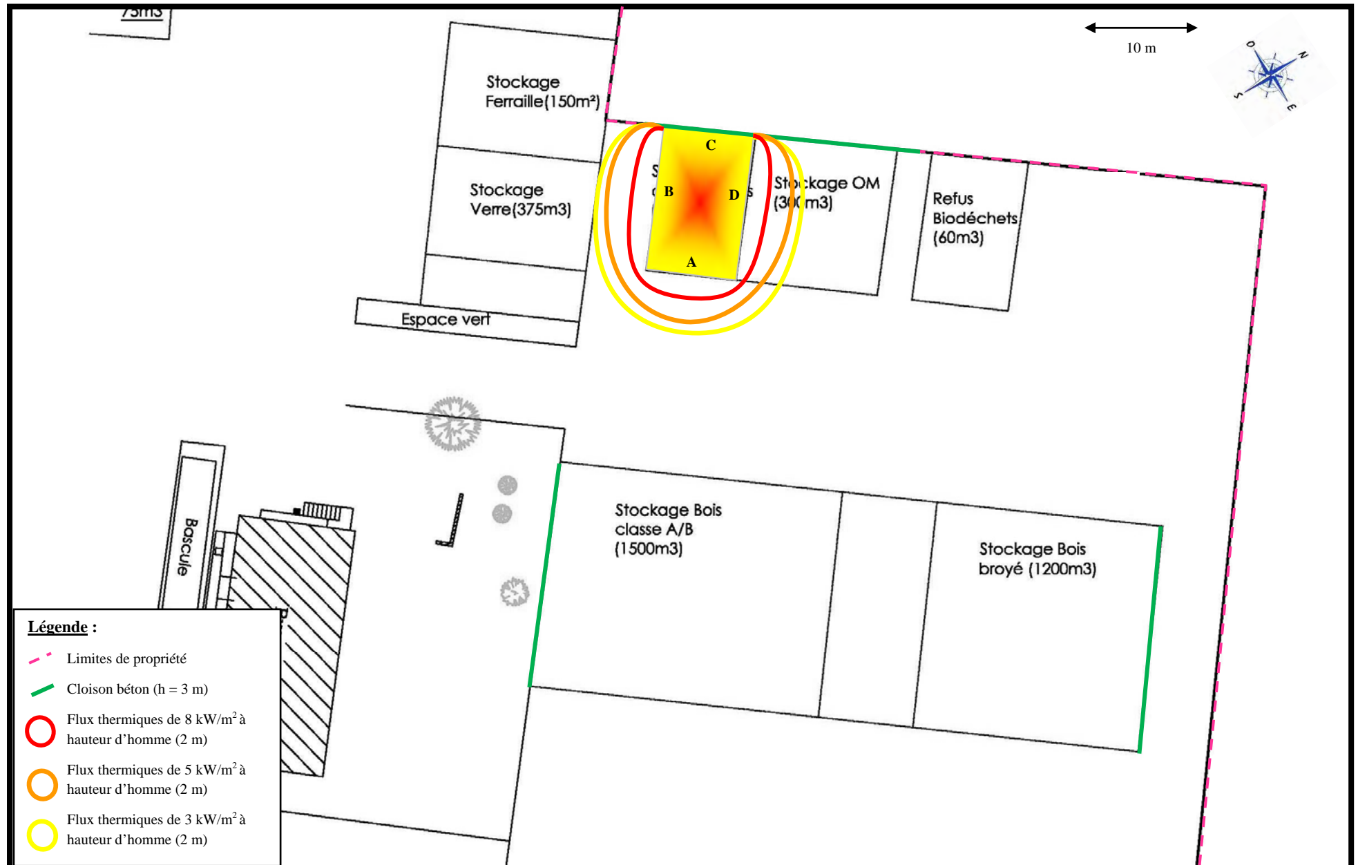
FIGURE 9 : INCENDIE DU STOCKAGE DE DECHETS VERTS
