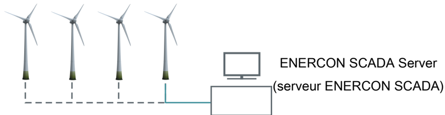
Fig. 13: Interruption d'une partie du bus de données sans management annulaire
