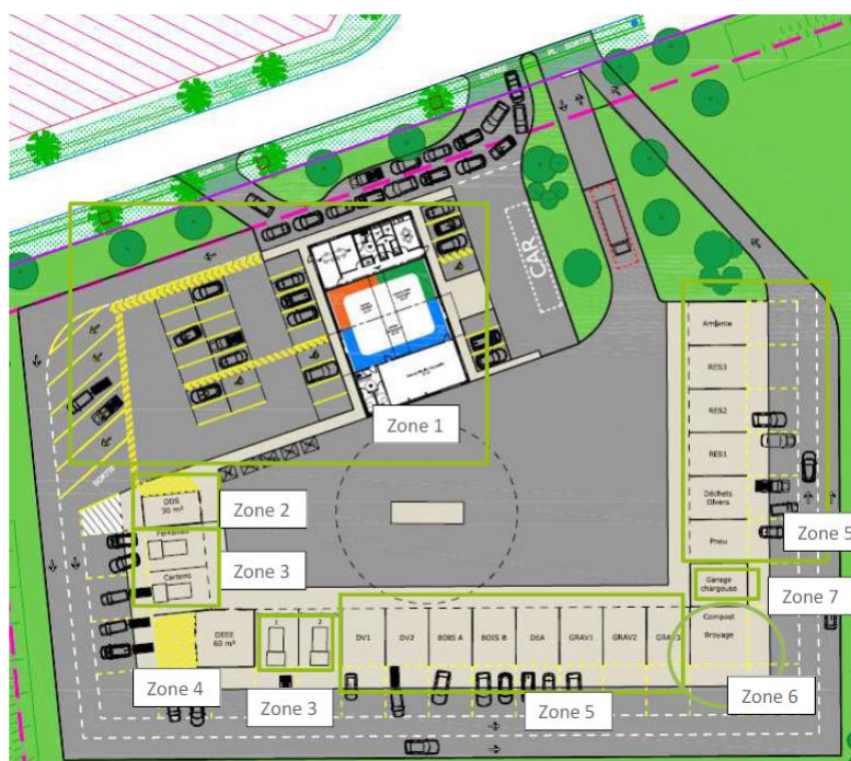
Figure 10 : Les différentes aires de dépose des déchets
