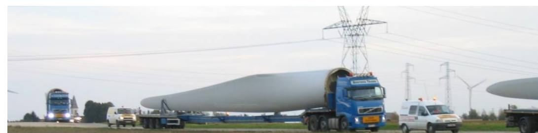
Figure 121 : Illustration du transport des pales (©ATER Environnement)
