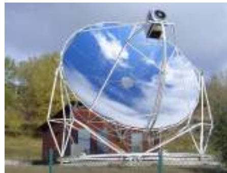
Les systèmes Dish Sterling à concentrateurs paraboliques et moteur Sterling au foyer (photo : prototype à Odeillo en Espagne)
