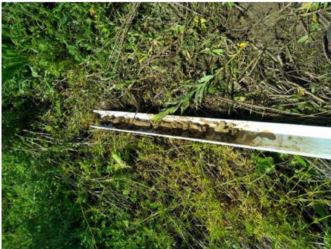
PHOTO 4 : SONDAGE 4 DE 0 À 120 CM
