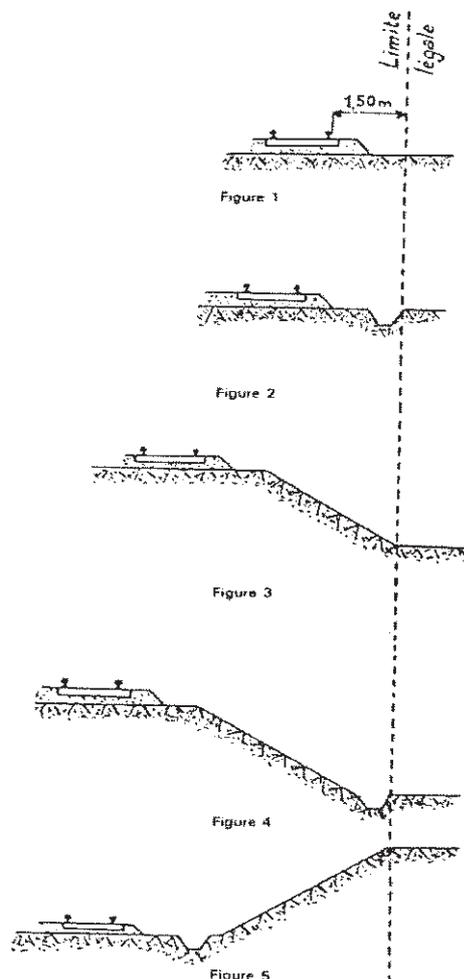
Dans le cas d'une voie posée à flanc de coteau, la limite légale à considérer est constituée par le point extrême des déblais ou remblais effectués pour la construction de la ligne et non la limite du talus naturel (figures 6 et 7)
