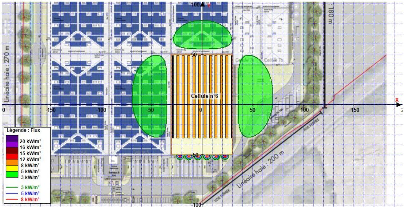
Figure 36 : Représentation des distances d'effets thermiques du Sc1 stockant des palettes 1510 (incendie de C6)
