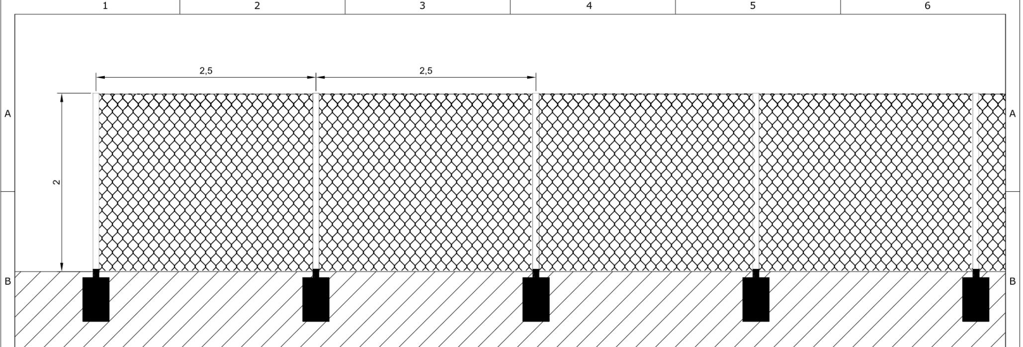
Vue de face: clôture fils acier soudés et poteaux de support
