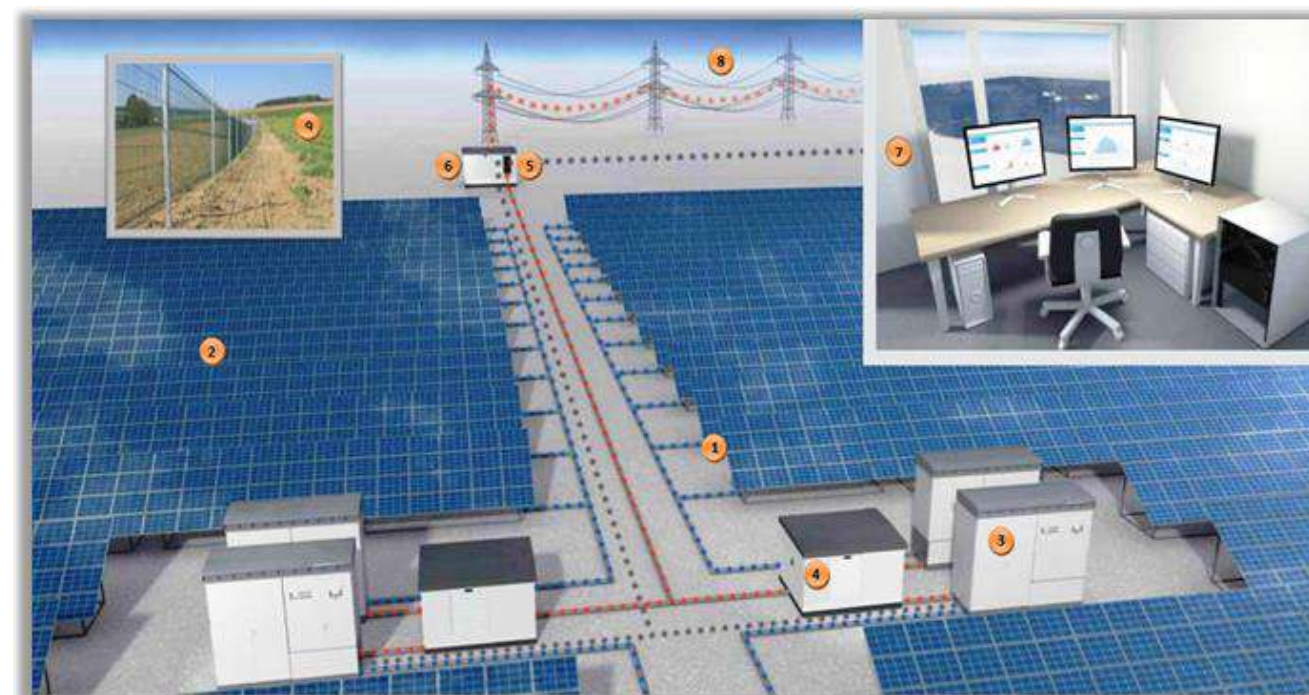
Figure 5 : Schéma de principe des composants d'un parc photovoltaïque au sol
