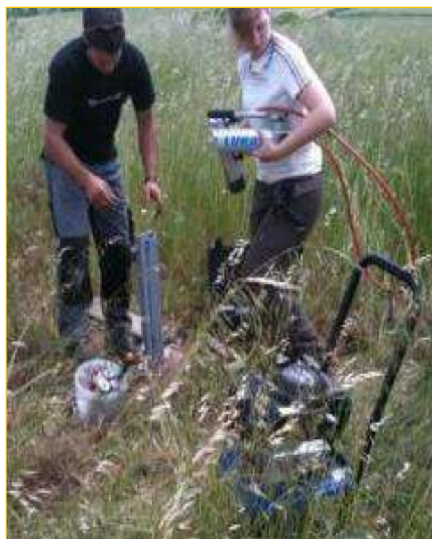
Figure 13 : Test de résistance à l'arrachage des pieux
