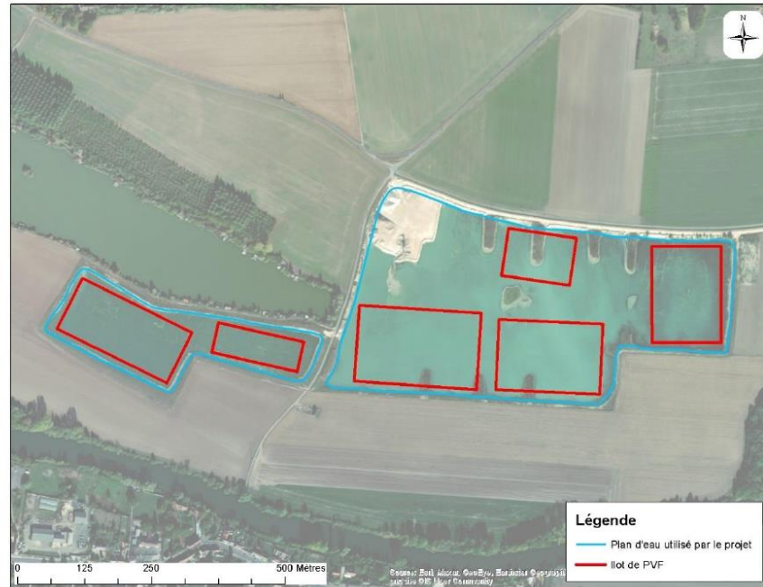
Figure 3 : Localisation des îlots de panneaux photovoltaïques flottants
