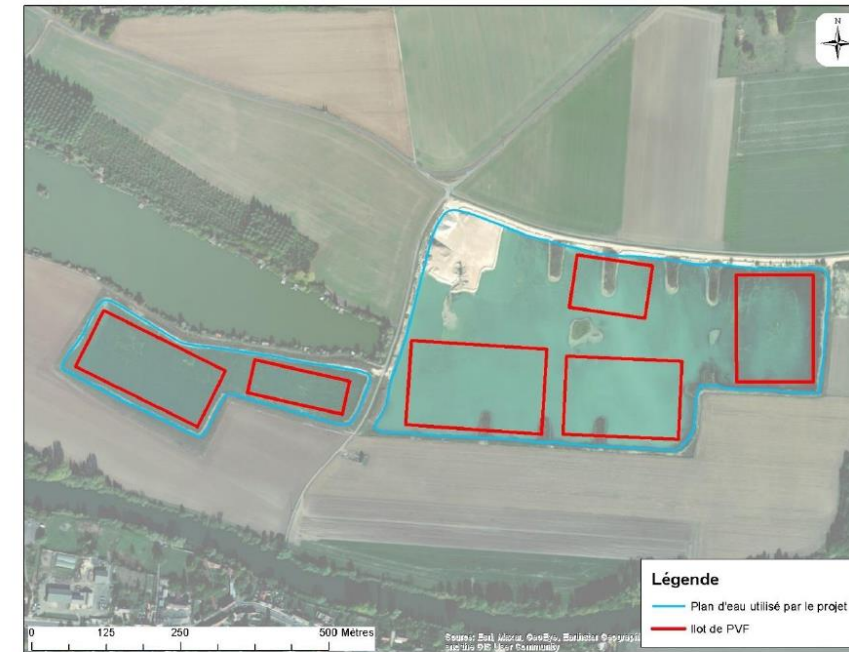
Figure 3 : Localisation des ilots de panneaux photovoltaïques flottants
