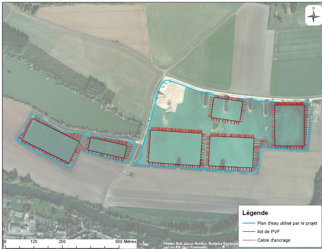
Figure 6 : Localisation des ancrages des ilots
